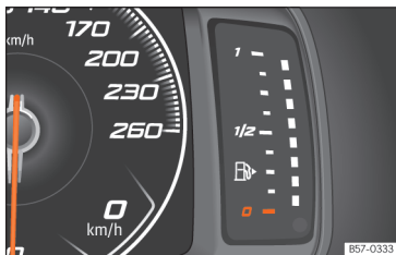
70. att. Brīvi konfigurējams mērinstrumentu bloks: degvielas daudzuma rādītājs.
