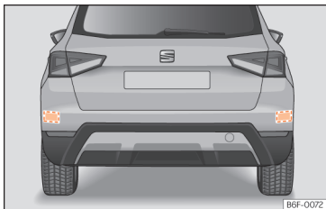
147. att. Automašīnas skats no aizmugures: radara sensoru atrašanās vietas.
