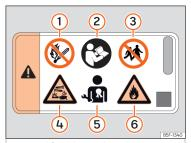
Fig. 232 48-volt battery: hazard warning
