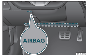
17. att. Vadītāja pusē: ceļgalu drošības spilvena uzstādīšanas vieta.
