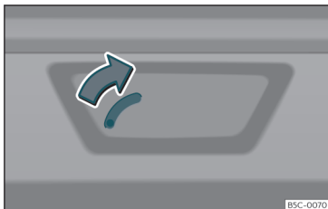
81. att. Bagāžas nodalījuma fragments: ārkārtas atslēgšanas veikšana.
