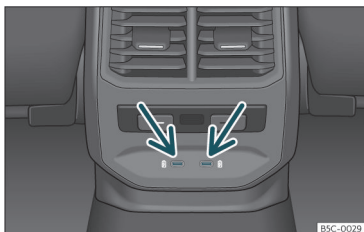
133. att. Viduskonsoles aizmugurē: USB pieslēgvietas ar elektriskās līgšanas funkciju.
