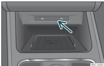
132. att. Viduskonsole: USB pieslēguma ligzda.
