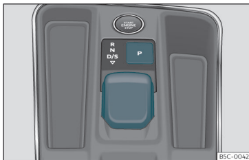
137. att. Viduskonsolē: selektora pārslēgs.
