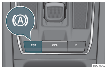
168. att. Viduskonsoles apakšdaļa: Auto Hold funkcijas taustiņš.
