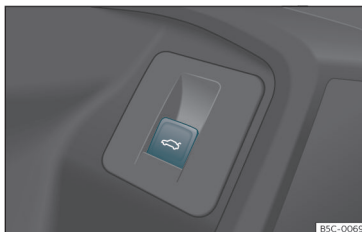
79. att. Uz vadītāja durvīm: taustiņš bagāžas nodaļuma durvju atvēršanai un aizvēršanai.
