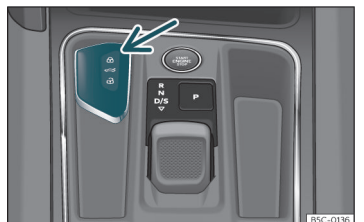
66. att. Viduskonsole: automašīnas atslēgas ligzda.
