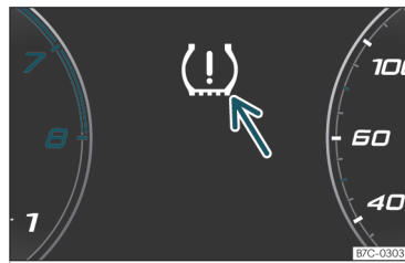
196. att. Mērinstrumentu bloks: brīdinājums par riepu spiediena zudumu.
