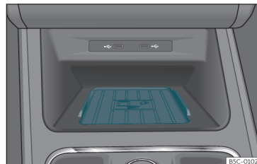
131. att. Viduskonsole: paliktņis mobilā telefona savienošanai.
