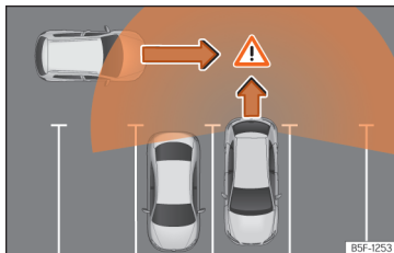
193. att. Izbraukšanas palīgsistēmas darbības shēma: kontrolētā zona aiz automašīnas, kas izbrauc no stāvvietas.
