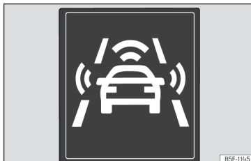
177. att. Mērinstrumentu bloka ekrānā: sākotnējā brīdinājuma rādījums.
