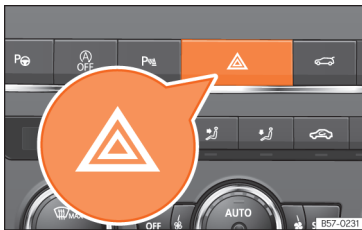
110. att. Instrumentu panelis: avārijas gaismu signalizācijas slēdzis.
