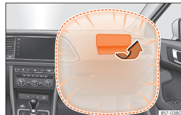
15. att. Priekšējā pasažiera drošības spilvens instrumentu panelī.
