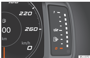
72. att. Brīvi konfigurējams mērinstrumentu bloks: degvielas daudzuma rādītājs.
