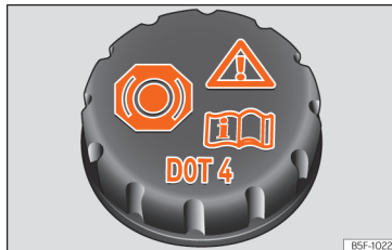
226. att. Motora nodalījums: bremžu šķidrums tvertnes vāciņš.
