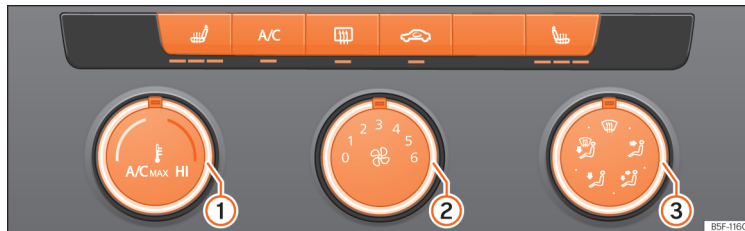
146. att. Viduskonsolē: klimata kontroles ierīces vadības elementi.
