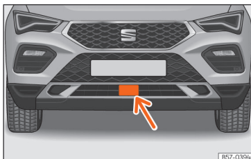
167. att. Priekšējā buferī: radara sensors.
