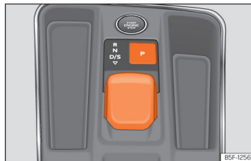
132. att. Viduskonsolē: selektora pārslēgs.
