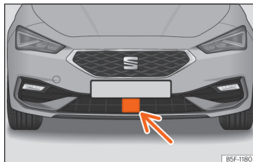
145. att. Priekšējā buferī: radara sensors.
