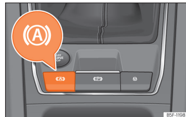
164. att. Viduskonsoles apakšdaļa: Auto Hold funkcijas taustiņš.
