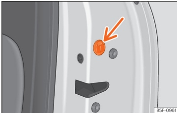
77. att. Durvju ārkārtas aizslēgs.
