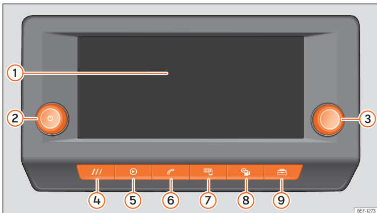
120. att. Vispārējs pārskats: vadības un displeja bloka 8,25 collu versija.
