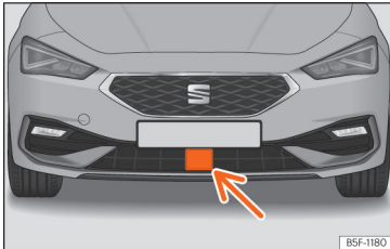
142. att. Priekšējā buferī: radara sensors.
