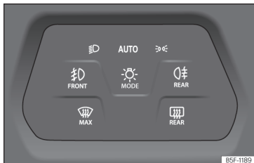
84. att. Instrumentu panelis: gaismu slēdzis.
