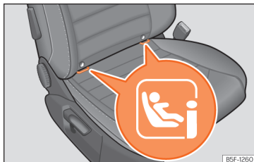
26. att. Priekšējā pasažiera sēdeklišs: ISOFIX stiprinājuma cilpas.
