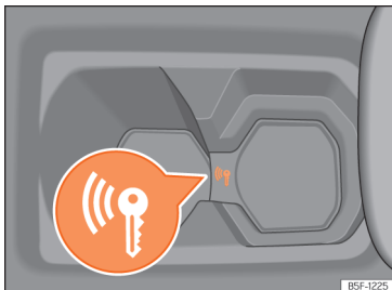
129. att. Viduskonsolē: ārkārtas iedarbināšana.
