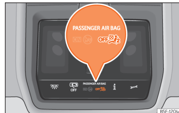
16. att. Griestu konsolē: kontrollampīna, kas norāda, ka priekšējā pasažiera drošības spilvens ir atslēgts.
