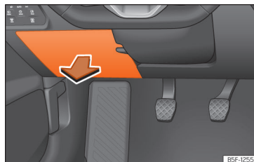
48. att. Instrumentu panelī vadītāja pusē: drošinātāju bloka vāks.
