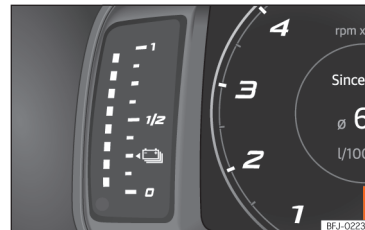
59. att. Mērinstrumentu bloks: akumulatoru baterijas uzlādes līmeņa rādītājs.
