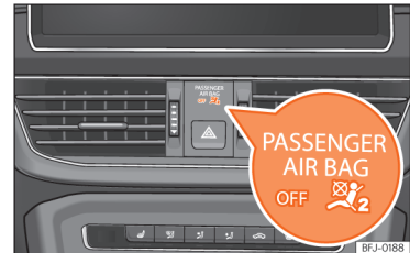
18. att. Instrumentu panelis: kontrollampīna, kas norāda, ka priekšējā pasažiera drošības spilvens ir atslēgts.
