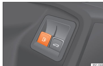
234. att. Vadītāja durvis: tvertnes vāciņa atbloķēšana.
