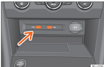
159. att. Viduskonsole: USB pieslēguma ligzda.
