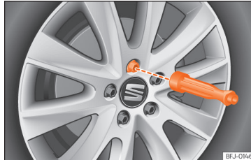
39. att. Riteņa nomaīņa: riteņa skrūvju izskrūvēšana, izmantojot skrūvgrieža rokturi.
