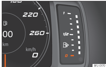
60. att. Brīvi konfigurējams mērinstrumentu bloks: degvielas daudzuma rādītājs.
