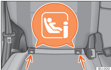
26. att. Otrās sēdekļu rindas malējie sēdekļi: ISOFIX/i-Size stiprinājuma cilpas.
