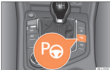
201. att. Viduskonsoles augšdaļā: taustiņš novietošanas manevra palīga ieslēgšanai.
