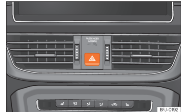
95. att. Instrumentu panelis: avārijas gaismu signalizācijas slēdzis.
