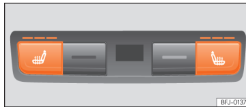
150. att. Viduskonsoles aizmugurē: aizmugurējo sēdekļu apsildes vadības elementi.
