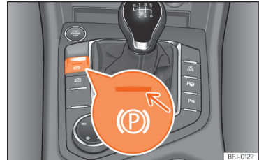
199. att. Viduskonsoles apakšdaļā: elektroniskās stāvbremzes taustiņš.
