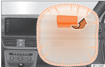
16. att. Priekšējā pasažiera drošības spilvens instrumentu panelī.
