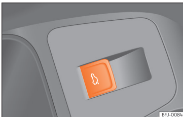
85. att. Uz vadītāja durvīm: taustiņš bagāžas nodalījuma durvju atvēršanai un aizvēršanai.
