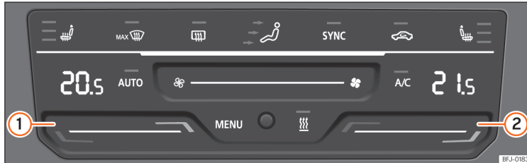
146. att. Viduskonsolē: Climatronic vadības elementi.
