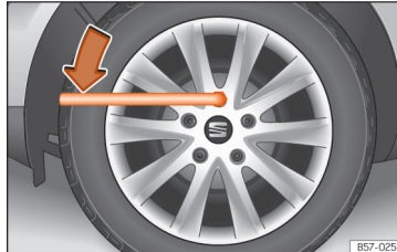
35. att. Riteņa nomaīņa: riteņa skrūvju palaišana vaļiņā.
