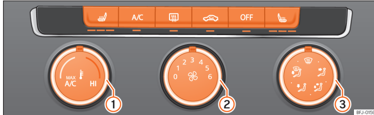
147. att. Viduskonsolē: klimata kontroles ierīces vadības elementi.
