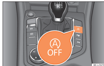
163. att. Viduskonsole: START-STOP sistēmas taustiņš.
