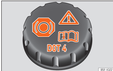
246. att. Motora nodalījums: bremžu šķidruma tvertnes vāciņš.
