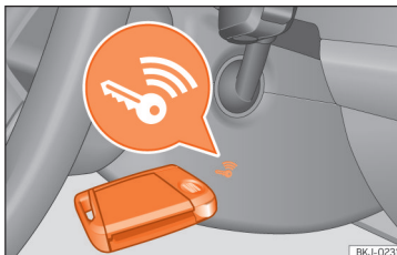
162. att. Stūres statņa labajā pusē: ārkārtas iedarbināšana.
