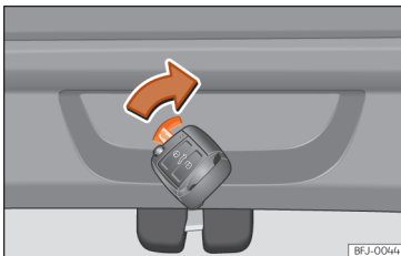
87. att. Bagāžas nodaļuma fragments: ārkārtas atslēgšanas veikšana.
