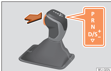
166. att. Selektora pārslēga drošinātājs.
