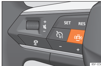
64. att. Daudzfunkcionālās stūres kreisajā pusē: vadītāja palīgsistēmu taustiņš (atkarībā no modeļa).
