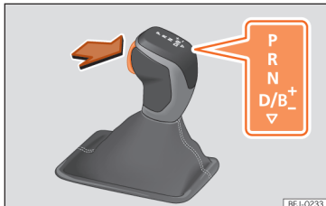
167. att. Selektora pārslēga drošinātājs (hibridautomobili).
