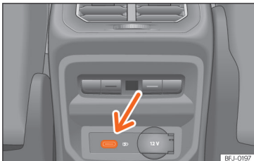
160. att. Viduskonsoles aizmugurē: USB pieslēgvietas ar elektriskās ligzdas funkciju.
