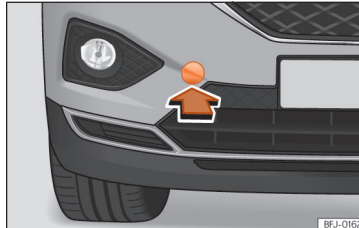
45. att. Priekšējā bufera labajā pusē: nosegvāciņa noņemšana.
