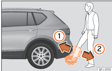
86. att. Bagāžas nodalījuma durvis ar sensoru vadāmu atvēršanu (Easy Open).
